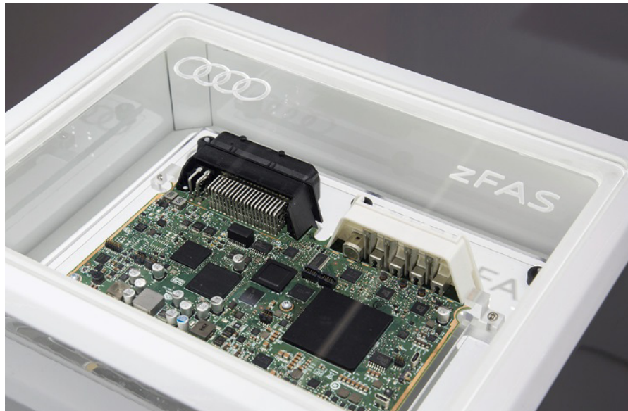
Fig. 18: Système zFAS d'Audi utilisant l'EyeQ3 de Mobileye
