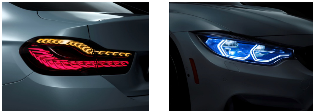
Fig. 8: Phares OLED avant et arrière de la BMW M4 Iconic Lights
